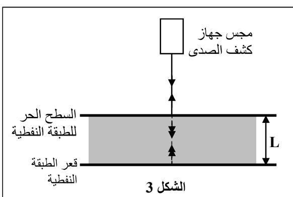
2. تحديد سمك طبقة جوفية من النفط لتحديد السمك L لطبقة جوفية من النفط ، استعمل أحد المهندسين محس جهاز الكشف بالصدى . يرسل المحس عند اللحظة  $t_0 = 0$  إشارة فوق صوتية مدتها جد وجيزة ، عموديا على السطح الحر للطبقة الجوفية من النفط .
