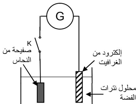
نغمر صفحة من النحاس كلياً في محلول مائي لنترات الفضة  $Ag^+_{(aq)} + NO^-_{3(aq)}$ ، ثم نصلها بواسطة سلك موصل بأحد قطبي المولد الكهربائي G، ونربط قطبه الآخر بالأنود من الغرافيت كما هو مبين في الشكل جانبه.
