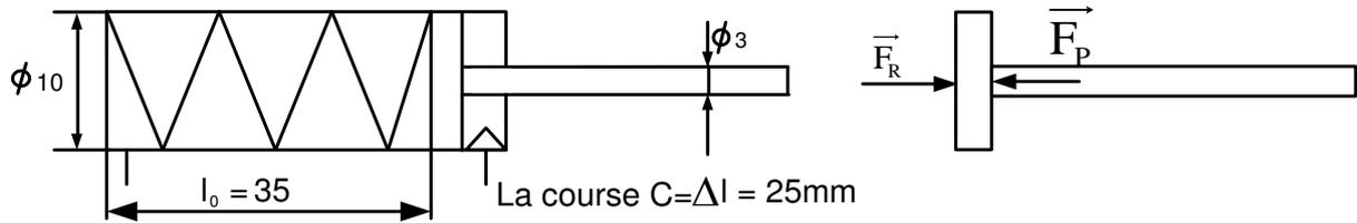
Pression d'utilisation :  $p = 3 \text{ à } 8 \text{ bar}$
