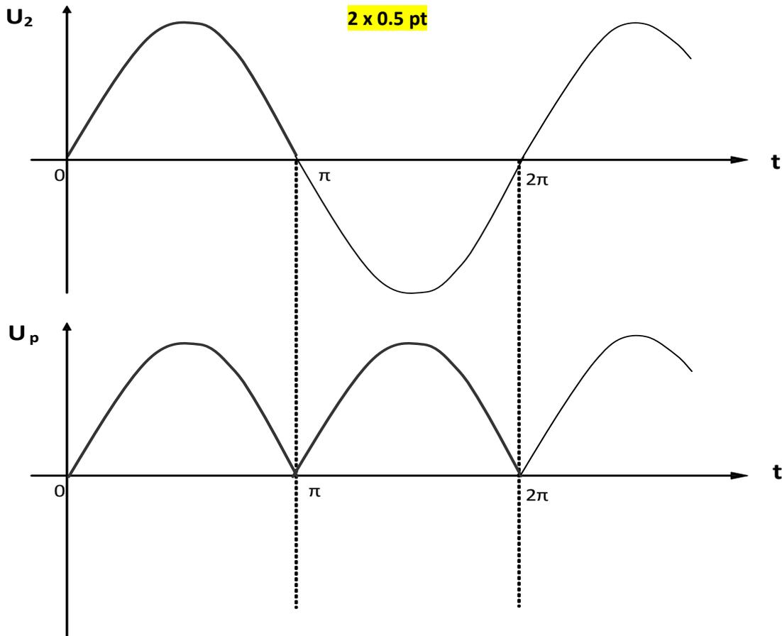
$$U_{p \text{ moyenne}} = 2 U_2 \text{ max} / \pi = 2 \cdot 78 \sqrt{2} / \pi = 70,22 \text{ V}$$
