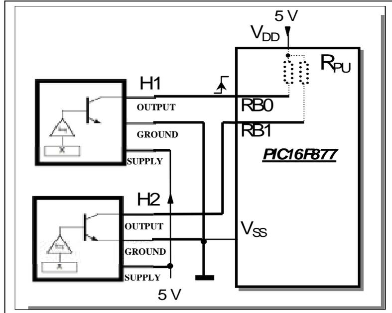
Compléter alors la séquence d'initialisation du PIC16F877, en tenant compte de la configuration adoptée (voir schéma du DRES 01 de la page 10 : configuration matérielle), où RB0 est utilisé comme entrée d'interruption active sur front montant. On note que : **4 pts**
