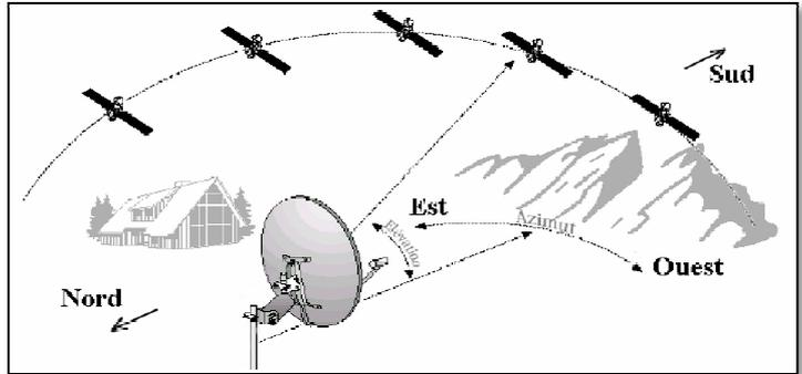
Quelques solutions techniques sont proposées dans le commerce pour pouvoir capter par la même parabole les émissions de plusieurs satellites. Parmi ces solutions, il ya celle qui consiste à équiper la parabole d'un moteur d'orientation automatique (parabole motorisée).
