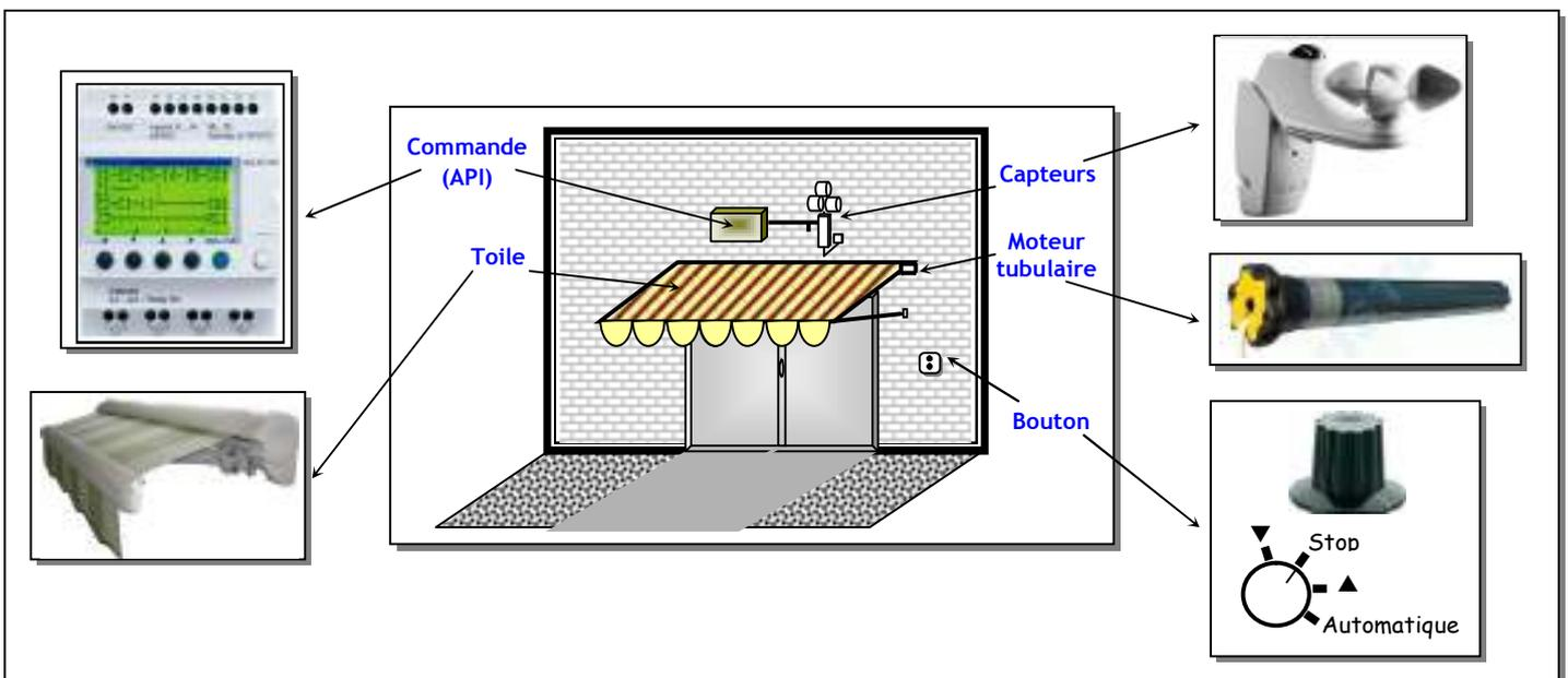
Le schéma complet de la commande du système est donné à la page 9. Pour être traitées par l'API, les informations Vent/Soleil ainsi que les commandes manuelles doivent être adaptées aux niveaux de tensions compatibles par l'API.
