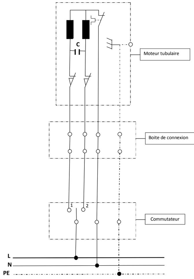
2) Le condensateur C permet le déphasage de 90° du champ magnétique dans la bobine principale par rapport au champ magnétique de la bobine secondaire, ce qui permet le démarrage du moteur monophasé.....1pt
