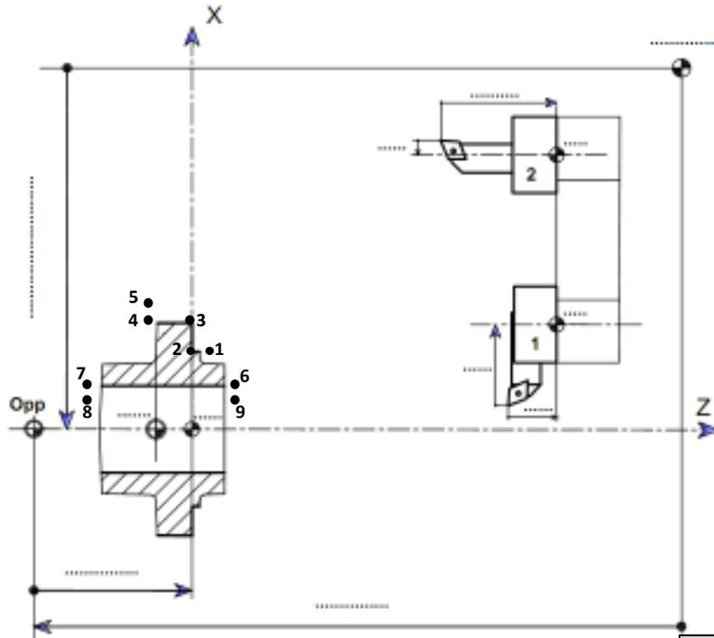
e-2- Compléter, en mode absolu **G90** et en utilisant le **DRES pages 17/18 et 18/18**, le tableau, ci-contre, par les coordonnées des points (profils finition) des cycles chariotage/dressage (**D2 et F1**), chariotage **D3** et alésage **D1** : /3,25pts
