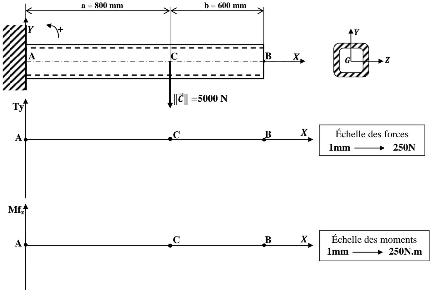
e- Déterminer, à partir de la condition de résistance en flexion et en prenant  $M_{fzMax}=4000N.m$ , le module de flexion  $\frac{IGZ}{\nu}$  en  $cm^3$  : **/1pt**
