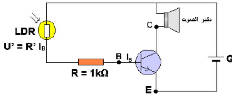
هذا التركيب يمكن من التحكم في مكبر الصوت بواسطة إضاءة المقاومة الضوئية L.D.R، في الضوء يصدر مكبر
