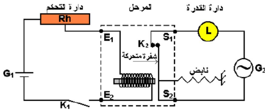
عند غلق قاطع التيار  $K_1$  تجذب نواة الكهرمغناط يس مما يؤدي إلى غلق قاطع التيار  $K_2$  (الشفرة المتحركة).
