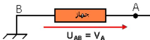
$U_{AB} = V_A - V_B$  وبما أن B مربطة بالهيكل فإن  $V_B = 0V$  أي أن  $U_{AB} = V_A$ . وفي هذه الحالة التوتر الكهربائي  $U_{AB}$  يساوي الجهد الكهربائي عند النقطة A.
