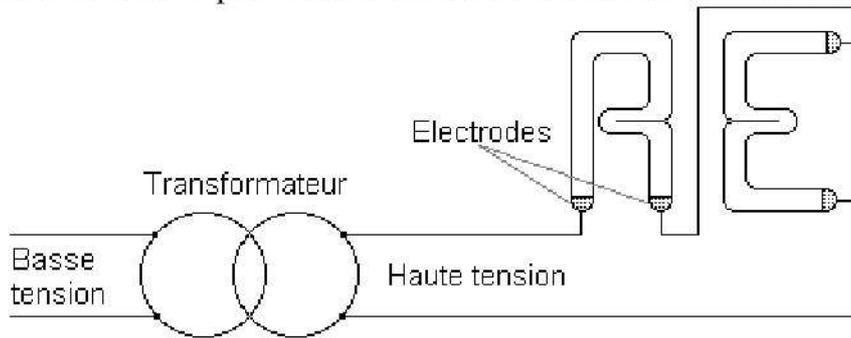
Les électrodes et la colonne gazeuse luminescente restent à température assez basse : d'où le nom de tube à cathode froide.
