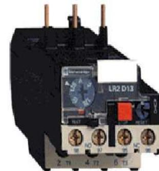
Le relais thermique utilise la propriété d'un bilame formé de deux lames minces ayant des coefficients de dilatation différents. L'apparition d'une surcharge se traduit par l'augmentation de la chaleur (effet joule) ; Le bilame détecte l'augmentation de chaleur, se déforme et ouvre le contact auxiliaire.
