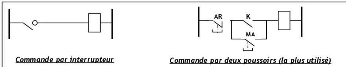
Si on appuie sur le bouton poussoir MA la bobine du contacteur est alimentée et ferme le contact K. Même si on relâche le bouton poussoir la bobine reste alimentée (automaintien). Pour couper l'alimentation il suffit d'ouvrir le bouton poussoir AR.
