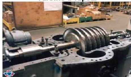
Turbine à vapeur
