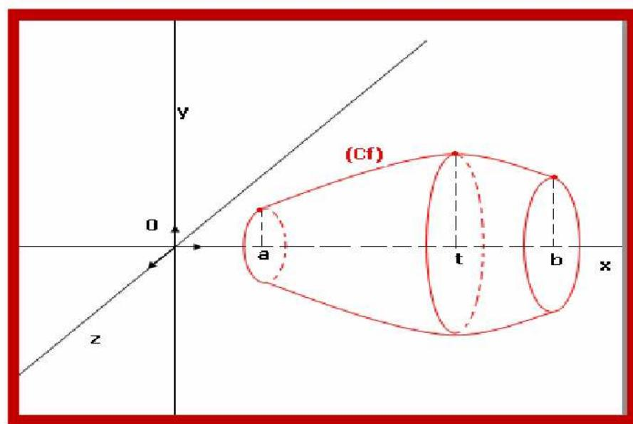
$$\text{حجمه هو } V = \int_a^b \pi f^2(x) dx \text{ بوحدة قياس الحجم}$$
