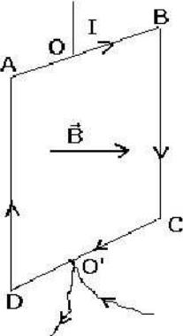
نعتبر إطاراً ABCD يمر فيه تيار كهربائي شدته  $I=5,0\text{A}$  موجود في مجال مغناطيسي شدته  $B=450\text{mT}$  نعطي :
