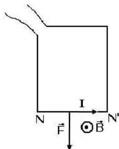
1 - عندما يكون التيار الكهربائي منعدما : تكون القوى المغناطيسية المطبقة على الإطار كذلك منعدمة وبالتالي يشير الدينامومتر في هذه الحالة إلى شدة وزن الجسم ( حسب شروط توازن جسم تحت تأثير قوتين ) .  $P=2N$
