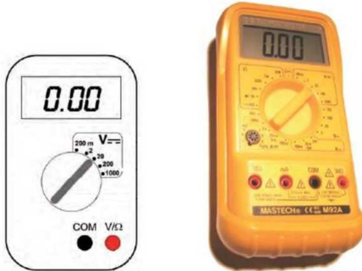
ويمثل الشكل أجزاء متعدد القياسات الخاصة بوظيفة الفولطметр.
