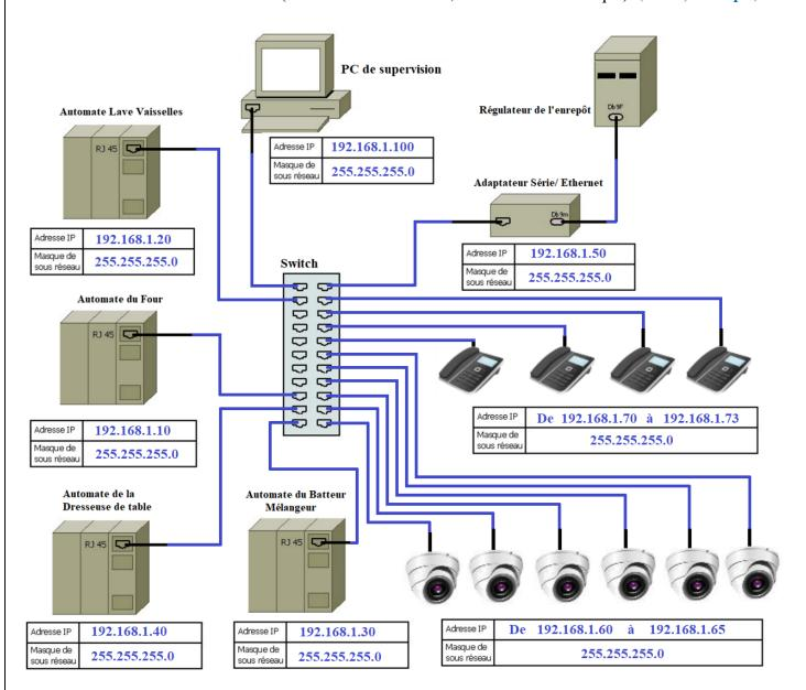
Les informations échangées sur le réseau Ethernet sont codées sur des bits transmis en série sur un support de transmission unique (pair torsadé) à un rythme imposé par une horloge. Chaque bit est représenté par un niveau de tension.
