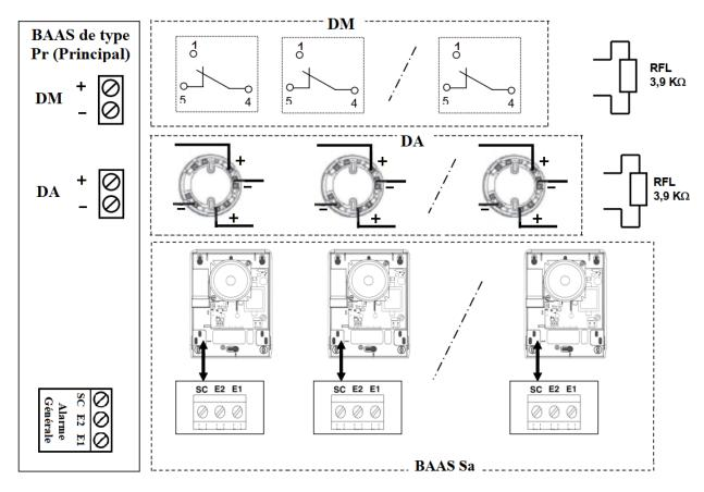
6) Que signifie résistance "RFL" ? Et quelle est sa fonction dans le câblage des déclencheurs manuels ? (1 pt)
