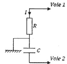
4. Un condensateur de capacité  $C$ , initialement déchargé, se charge à travers une résistance  $R$ . La tension permanente à ses bornes est égale à  $20V$ . L'instant où la tension aux bornes de la résistance a égalé  $7.4V$  est :
