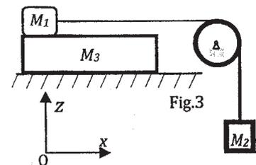
8. En considérant :  $M_1=M_2=M$ ,  $M_3=4M$ ,  $J=0$ , déterminer les accélérations  $\gamma_1$  et  $\gamma_3$  des blocs  $M_1$  et  $M_3$  en fonction de  $g$  et  $\mu$ .
