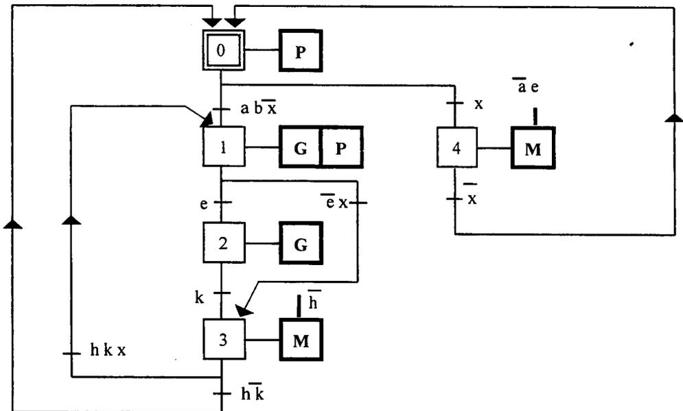
Etablir les équations des bascules JK si la réalisation est synchrone.
