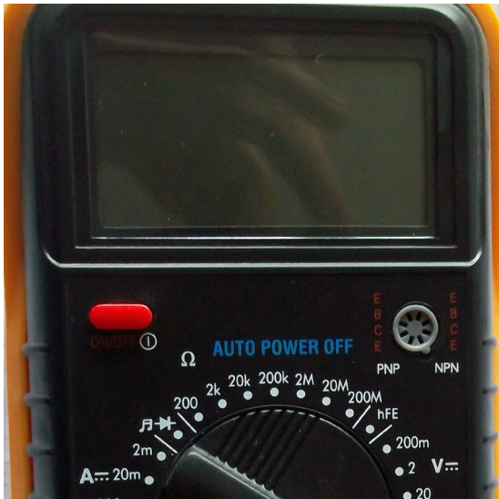
لقياس قيمة المقاومة نحدد OHM في الجهاز المتعدد القياسات
