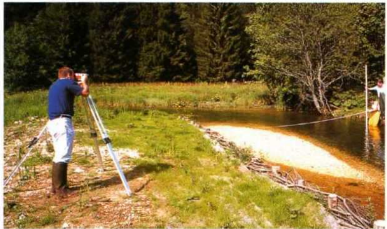
Un méandre reconstitué dans l'ancien lit de la rivière, un an après sa remise en eau. Des techniciens mesurent l'évolution du méandre.
