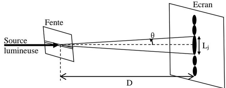
La tache centrale a une largeur  $L_j = 8,7 \text{ mm}$  (figure ci-contre).
