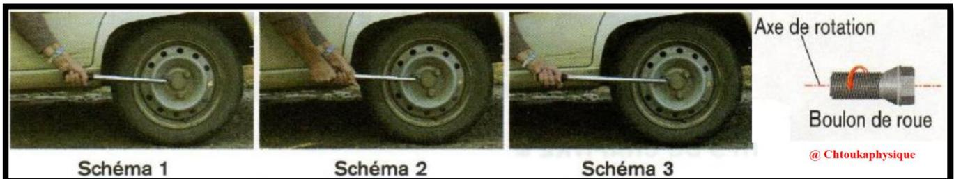
La personne appuie sur le manche de la clé (schéma 1), mais l'effet de rotation de la force exercée par sur le manche de la clé est insuffisant. Pour tenter de desserrer le boulon, la personne peut :
