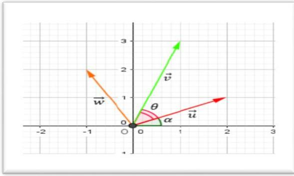
$\vec{u}(x; y)$  et  $\alpha$  la mesure de l'angle polaire  $(\vec{i}; \vec{u})$
