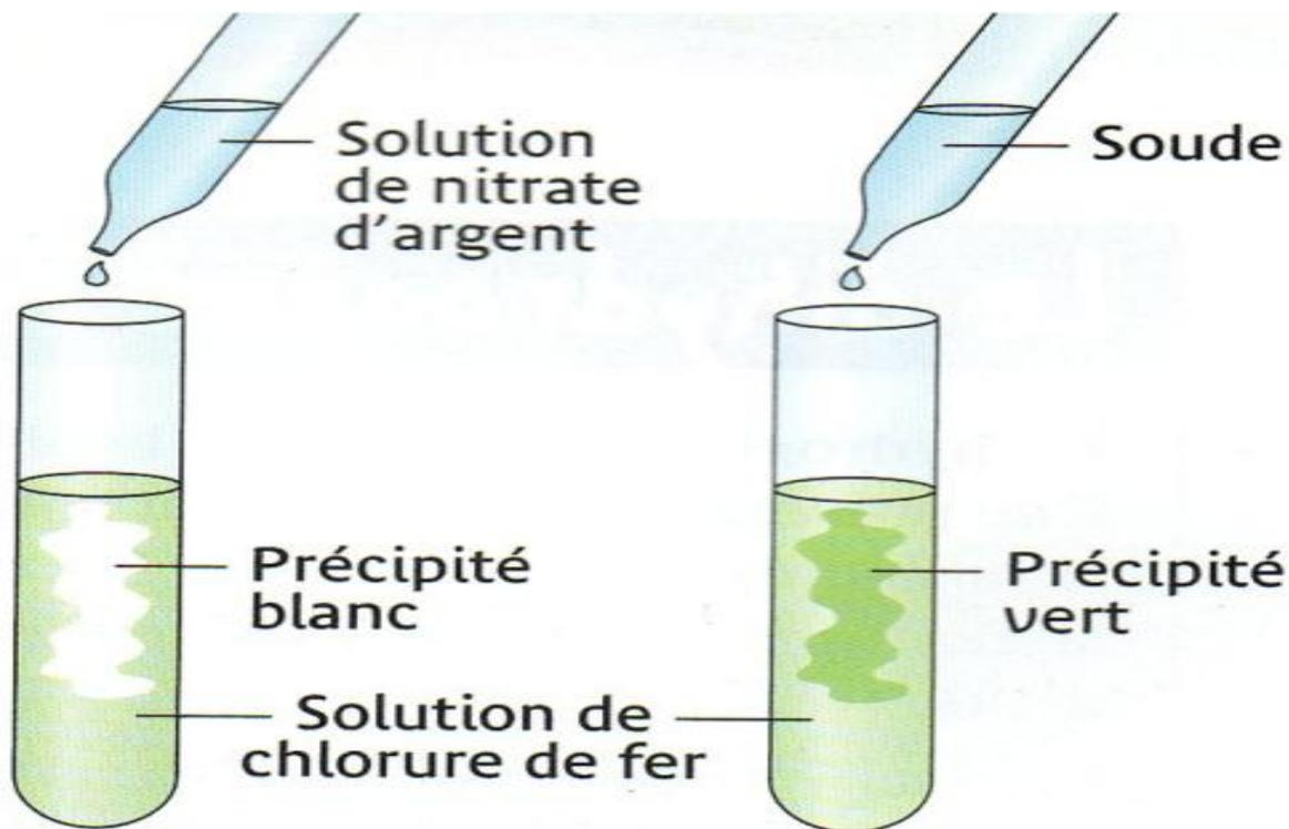
On observe la formation d'un précipité blanc et un précipité vert, ce qui prouve la présence des ions de chlorure  $\text{Cl}^-$  et de fer II  $\text{Fe}^{2+}$ .
