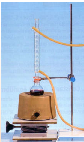
Fig. 1. Chauffage à reflux du mélange de linalol et d'anhydride acétique. La réaction s'effectue à température élevée et sans perte de matière.
