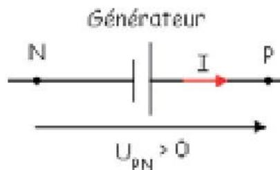
Dans la convention générateur, les flèches symbolisant l'intensité du courant et la tension aux bornes du générateur sont de même sens.
