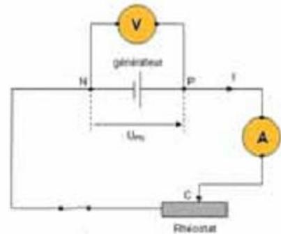
1. Ouvrir l'interrupteur et relever les valeurs de l'intensité  $I$  du courant et de la tension  $U_{PN}$  aux bornes du générateur.
