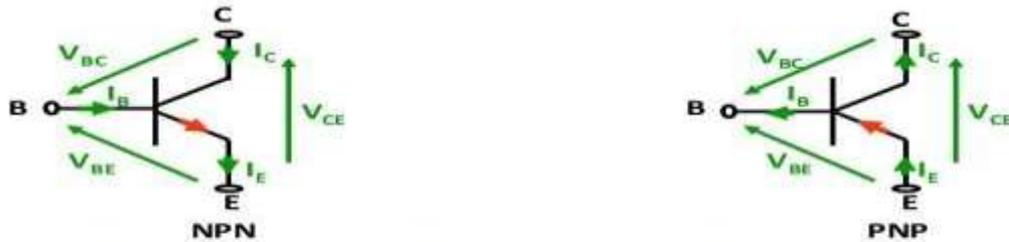
► Le transistor est une maille de tension et un nœud de courant
