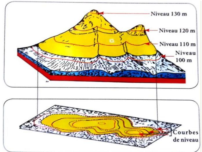
Figure 1 : modèle de projection des couches sur un fond topographique
