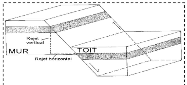
Les failles sont représentées par des traits plus épais que les courbes de niveau, ces traits sont accompagnés par des petits triangles dans le cas d'une faille inverse, des petits rectangles dans le cas d'une faille normale et par des signes + dans le cas d'une faille verticale.
