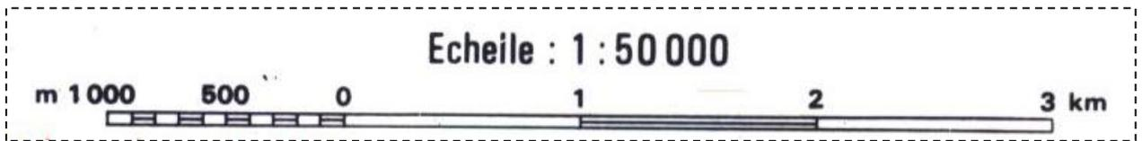
L'échelle d'une carte est le rapport  $d / D$  entre la distance réduite mesurée sur la carte ( $d$ ) et la distance réelle correspondante sur le terrain ( $D$ ), elle est exprimée sous forme d'une fraction :
