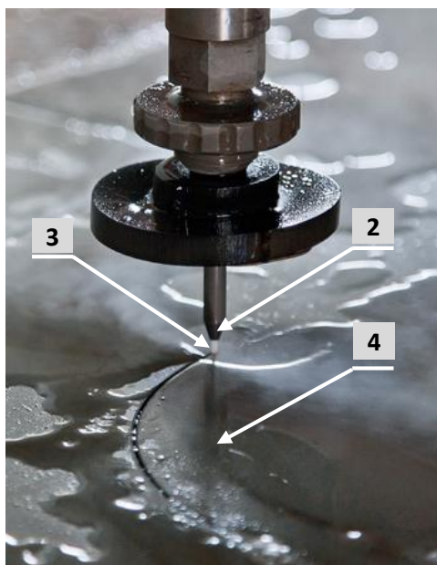
1 : Entrée d'eau à Très Haute Pression THP. 2 : Buse de \varnothing 0,1 mm.
