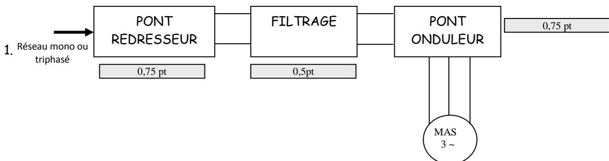
La tension monophasée ou triphasée du réseau est convertie en une tension continue par l'intermédiaire du pont redresseur et des condensateurs de filtrage. Cette tension continue est découpée par un pont onduleur pour donner une succession d'impulsions de largeur (M.L.I) modulation de largeur d'impulsions. 2 pts
