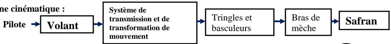
Schéma du système de direction mécanique :
