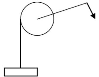
a. Le treuil tourne de  $n = 10$  tours. Le couple moteur fournit un travail égal à celui effectué par la force  $\vec{F}$  lors de la relation précédente. Calculer le moment  $M'$  du couple moteur.
