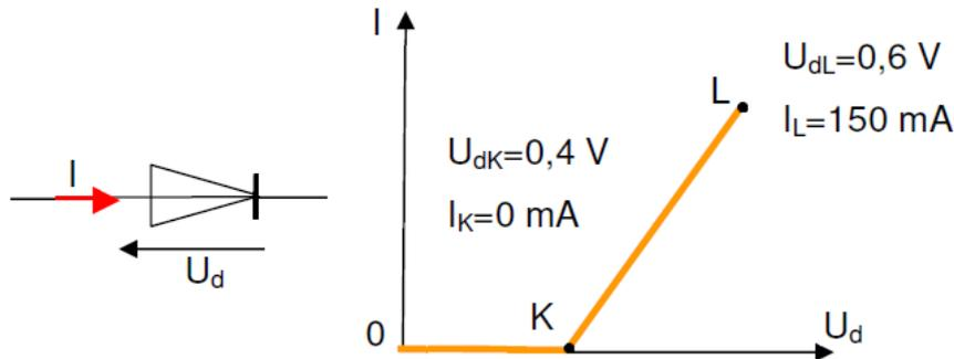
Déterminer par le calcul et graphiquement les coordonnées du point de fonctionnement lorsque la diode est placée dans le sens passant dans le circuit.
