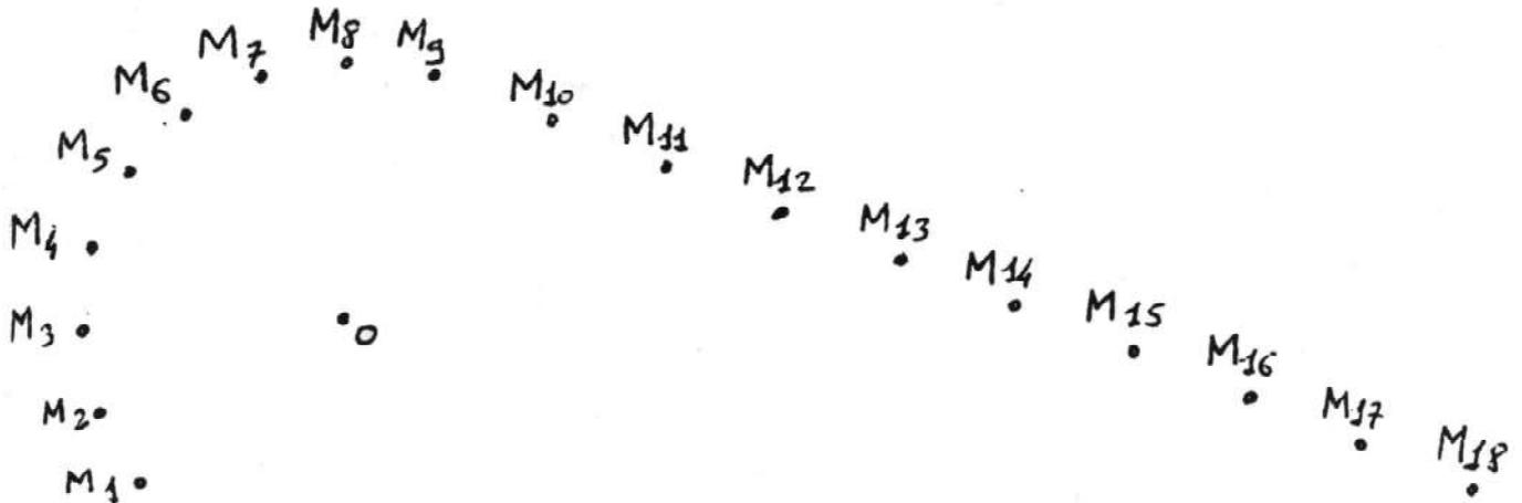
1. on constate au vu de l'enregistrement que le mouvement du point M peut se décomposer en deux phases distinctes.
