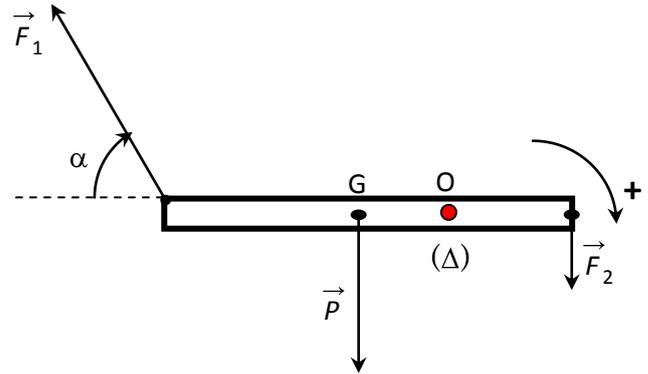
Ces forces sont dans un plan perpendiculaire à l'axe ( $\Delta$ ). On donne  $AB = 1$  m ;  $OG = 20$  cm ;  $\alpha = 60^\circ$
