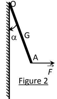
**Exercice 2** Une barre homogène AB, de masse  $M = 2,0 \text{ kg}$  et de longueur  $\ell=80\text{cm}$ , est mobile sans frottement autour d'un axe horizontal passant par le point O. A l'extrémité A, telle que  $OA = 20 \text{ cm}$ , on a accroché une masse  $M_1= 5,0 \text{ kg}$  de très petites dimensions. Pour maintenir l'équilibre de cette barre dans une position faisant un angle  $\theta = 60^\circ$  avec l'horizontale, un opérateur exerce une force  $\vec{F}$  perpendiculaire à la barre.
