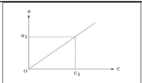
Cette courbe d'étalonnage permet ensuite de retrouver la concentration inconnue de la solution à doser à partir de la mesure de la conductance
