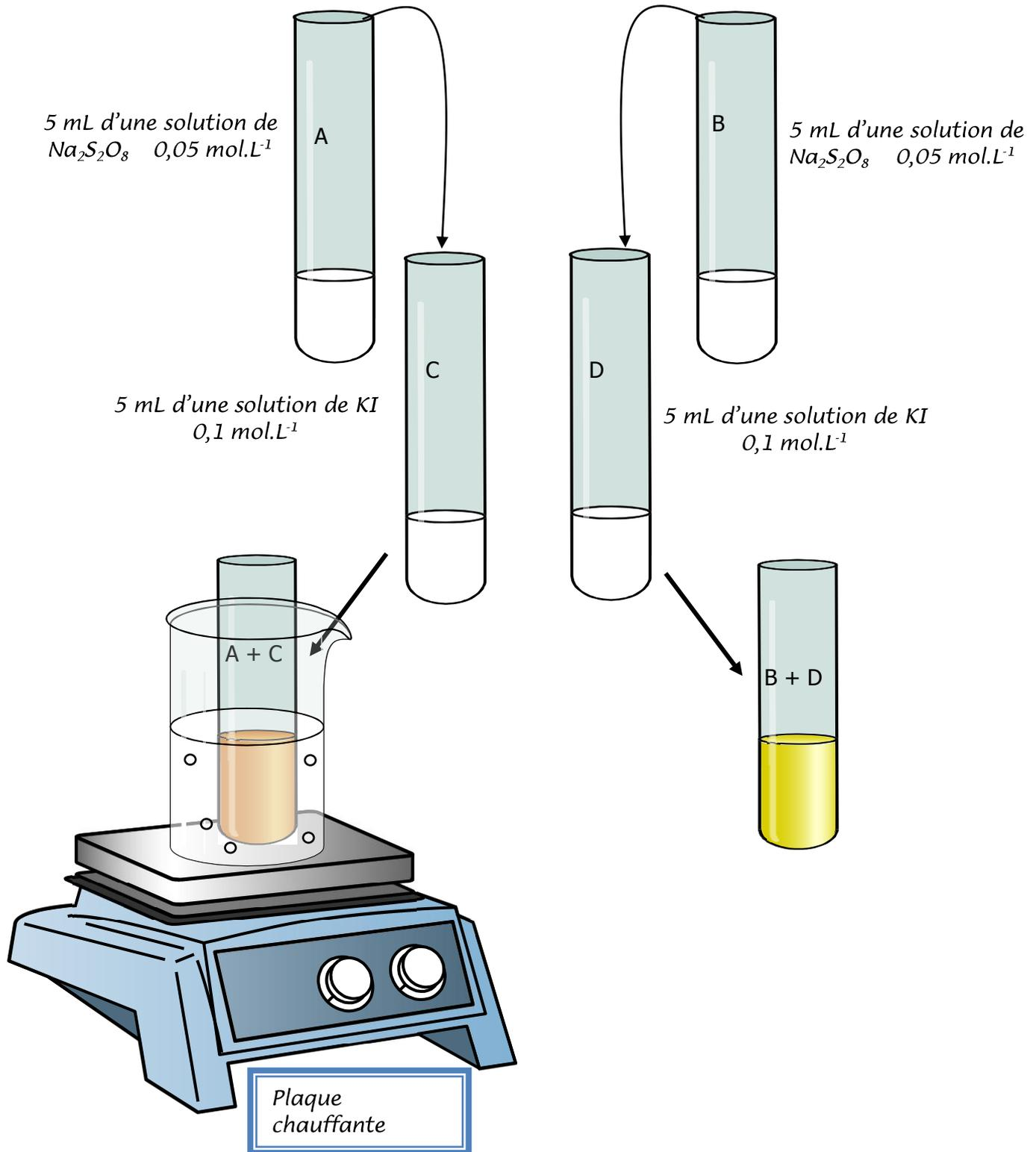
Verser simultanément le contenu du tube à essai A dans C et celui de B dans D. Notez vos observations :
