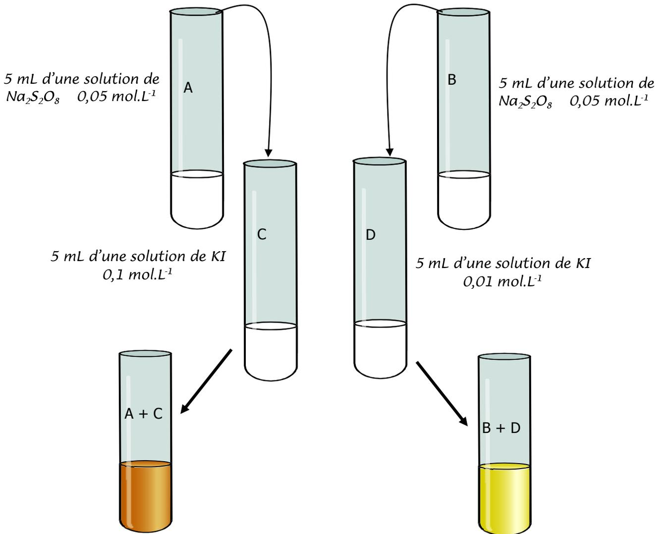
Verser simultanément le contenu du tube à essai A dans C et celui de B dans D. Notez vos observations :
