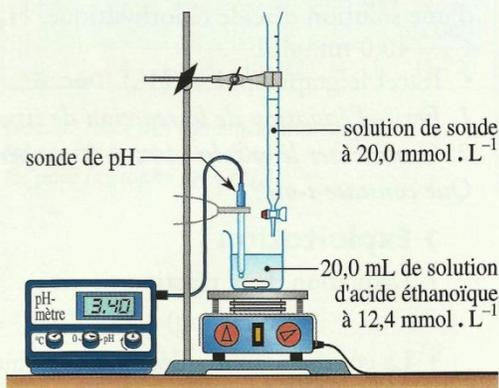
Doc. 3 Dispositif de suivi pH-métrique d'une réaction.
