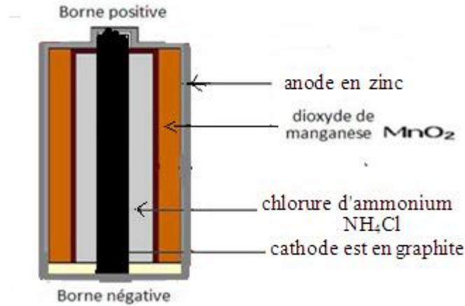
L'anode est le zinc, elle se consomme durant le fonctionnement par oxydation anodique selon la demi-équation suivante:
