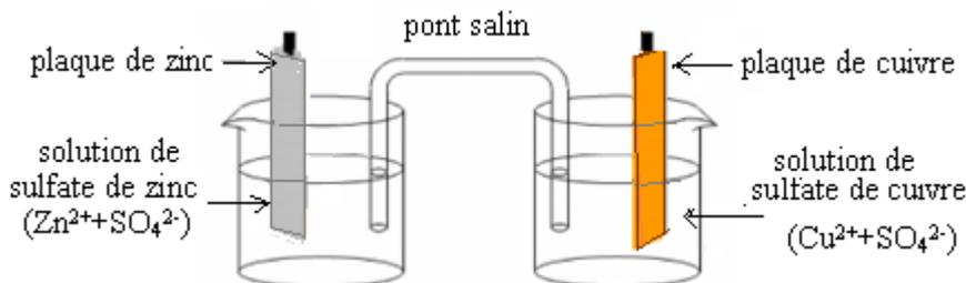
On a ainsi réalisé une pile électrochimique.
