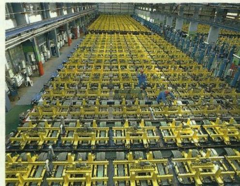
**Doc. 10** Électrolyse industrielle de solutions de chlorure de sodium à 300 g . L<sup>-1</sup> (saumure). Les anodes sont en titane recouvert d'oxydes de titane et de ruthénium ; les cathodes sont en acier ou en nickel. L'intensité du courant continu est voisine de 50 kA.
