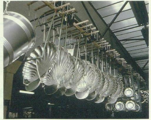
Doc. 11 L'argenture est réalisée par électrolyse.
