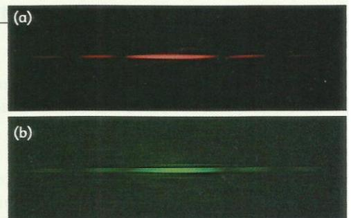
Doc. 5 Figures de diffraction de la même fente, obtenues avec des faisceaux laser de longueurs d'onde différentes : (a) laser rouge :  $\lambda_{\text{rouge}} = 650 \text{ nm}$  ; (b) laser vert  $\lambda_{\text{vert}} = 530 \text{ nm}$ . (Les échelles de représentation sont identiques.)
