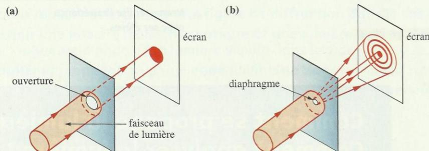
◀ **Doc. 3** Avec un diaphragme de large ouverture, la diffraction ne se produit pas (a). Avec un diaphragme de petite ouverture, on obtient une figure de diffraction (b).
