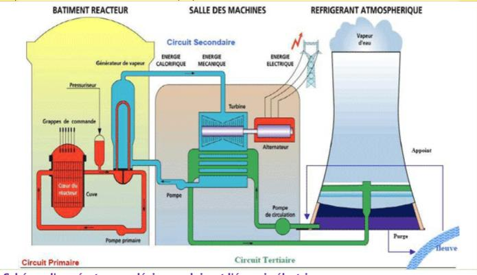
Schéma d'un réacteur nucléaire produisant l'énergie électrique
