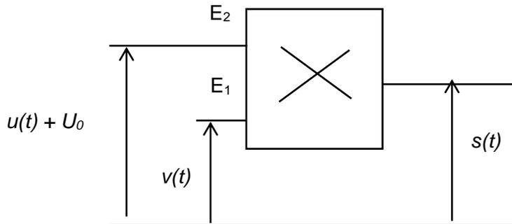
2.1.1. On applique aux entrées  $E_1$  et  $E_2$  les tensions  $v(t)=V_m \cos 2\pi Ft$  et  $u(t)=U_m \cos 2\pi ft$  telles que  $F \gg f$ .
