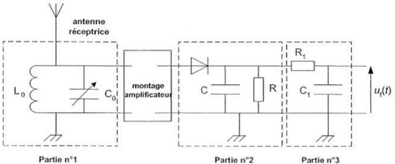
3.1. La partie n°1 est constituée d'une bobine d'inductance  $L_0 = 2,5$  mH et d'un condensateur de capacité  $C_0$  ajustable, l'ensemble constituant un dipôle  $L_0C_0$  en dérivation. Ce dipôle oscille avec une fréquence propre dont l'expression est :  $f_0 =$
