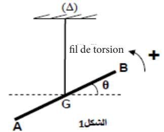
0. En appliquant la relation fondamentale de la dynamique dans le cas de la rotation autour d'un axe fixe, déterminer que l'équation différentielle du mouvement du système étudié .
