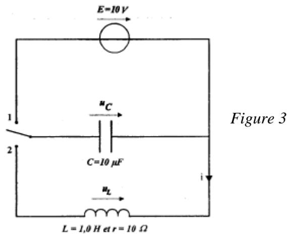
On bascule le commutateur en position 1 pour charger le condensateur puis on le bascule en position 2. Avec le même système d'acquisition et de traitement qu'au 1, en adaptant le paramétrage, on enregistre la tension  $u_c(t)$  dont le graphe est représenté sur la figure 5.
