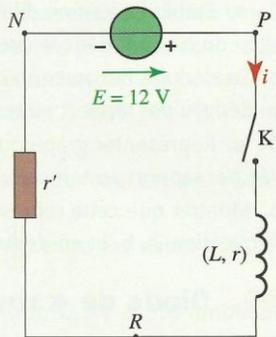
**c.** Vérifier que l'expression  $i(t) = \frac{E}{r+r'} \left(1 - \exp\left(-\frac{t \cdot (r+r')}{L}\right)\right)$  est solution de l'équation différentielle.
