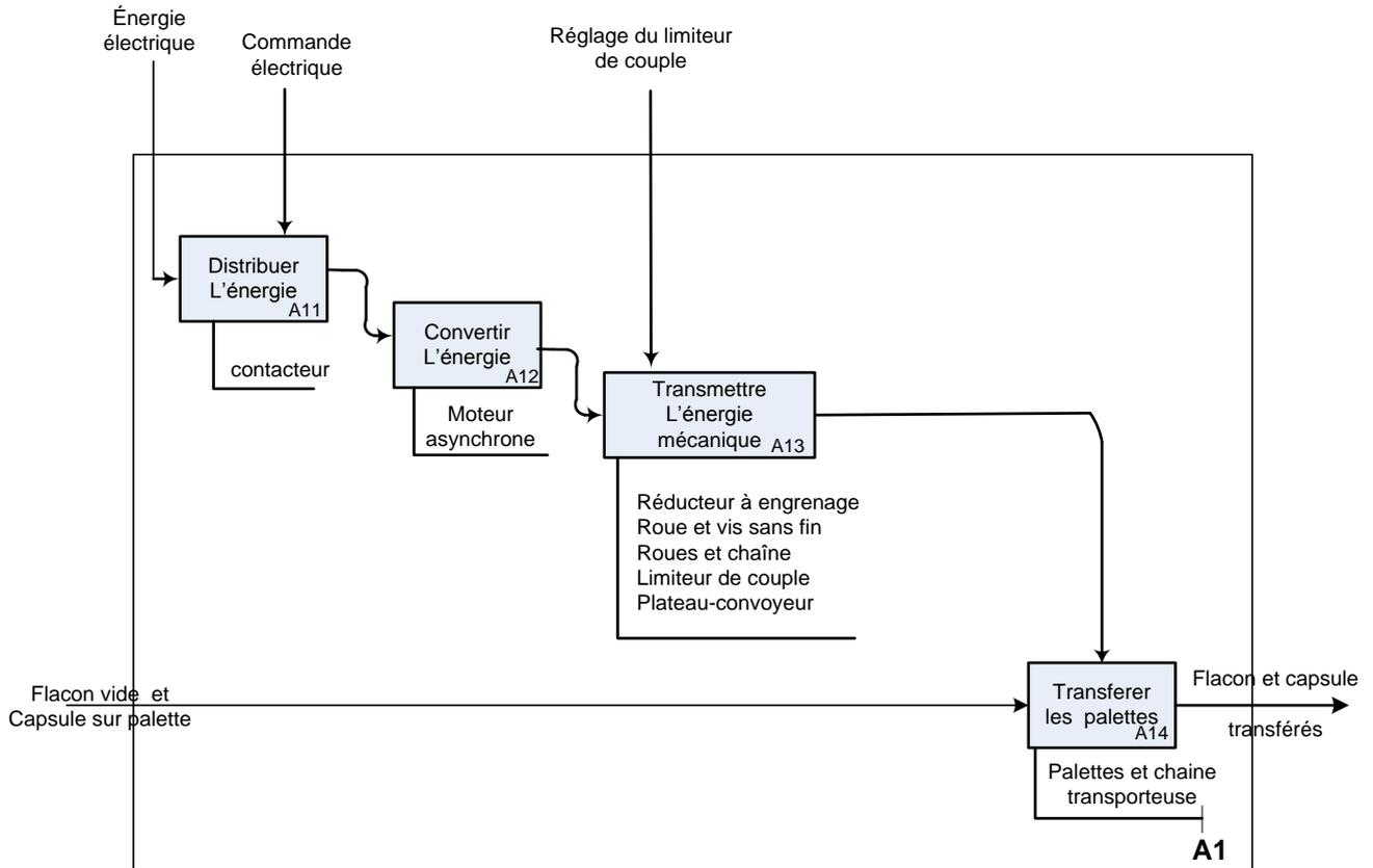
1.1.2 Compléter le tableau par la désignation et la fonction des composants du circuit électrique du moteur du convoyeur.
