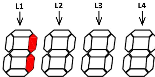
d- Compléter le tableau de fonctionnement des segments des quatre afficheurs affichant la masse de la charge soulevée de 1624 kg (segment allumé : 1 ; segment éteint : 0) /1pt
