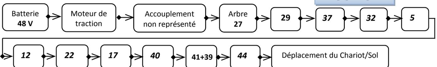
d- Le schéma cinématique minimal du mécanisme de traction: /2 pts
