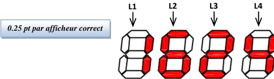
d- Le tableau de fonctionnement des segments des quatre afficheurs affichant la masse de la charge soulevée de **1624 kg** (segment allumé : **1** ; segment éteint : **0**). /1pt
