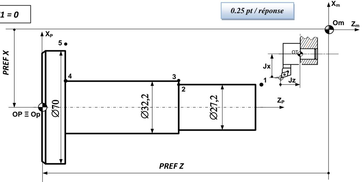
b. Le tableau des coordonnées du profil ébauche (points 1 à 5) en mode absolu G90 :
