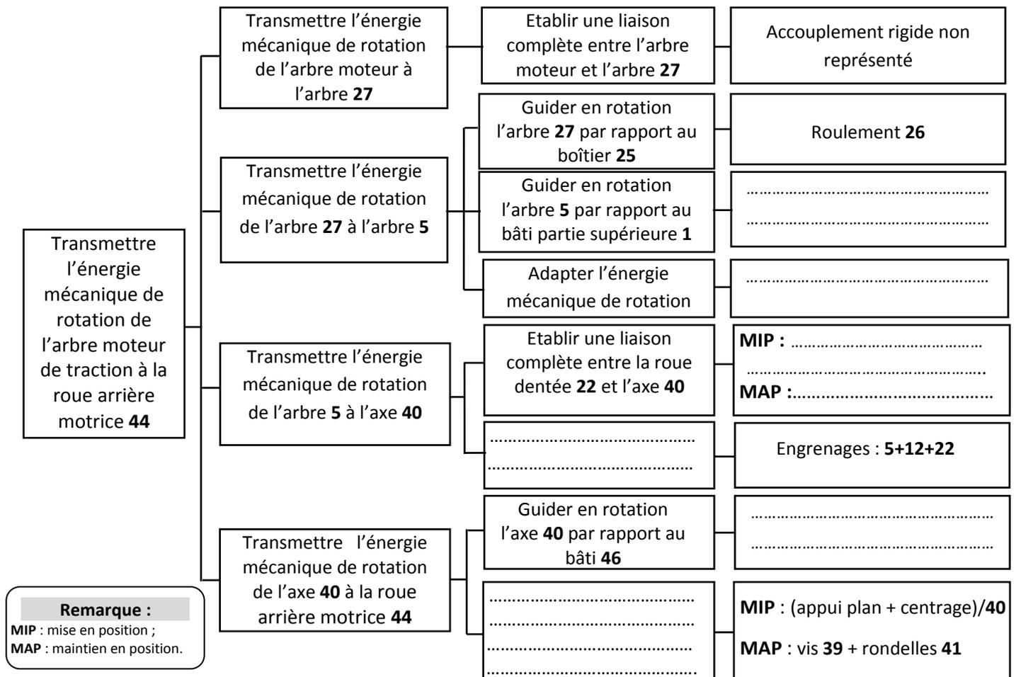
c- Compléter, par leurs repères, les éléments du graphe cinématique du mécanisme de traction qui permettent la transmission du mouvement de l'arbre 27 à la roue arrière motrice 44 :
