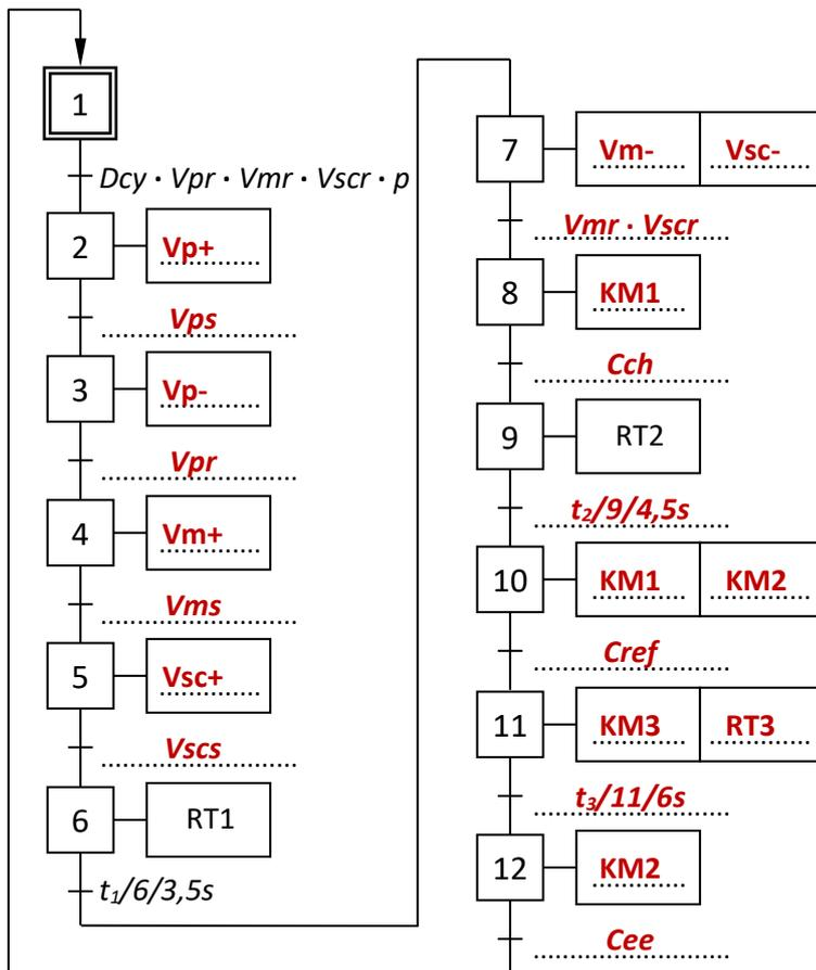
b. Compléter le grafctet partiel de point de vue API de l'opération de soudure et de découpe :
