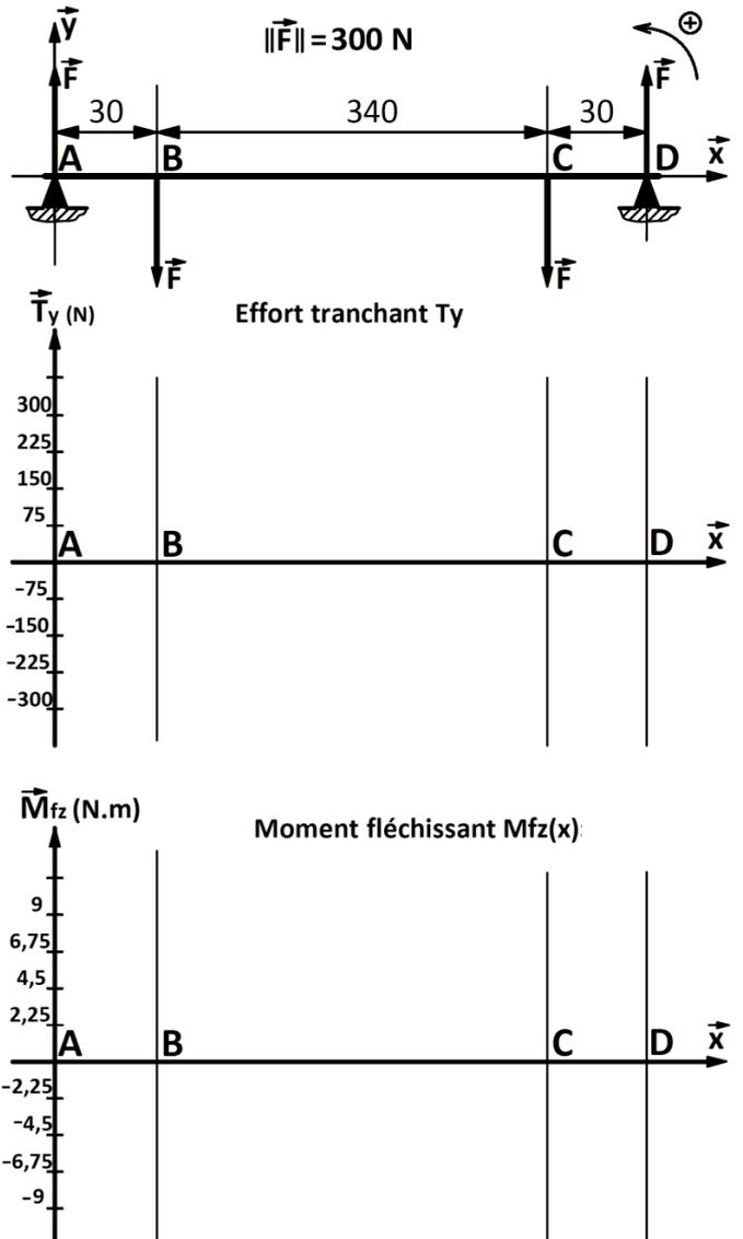
b. Tracer sur les graphes ci-dessus les diagrammes de l'effort tranchant  $T_y$  et du moment fléchissant  $M_{fz}(x)$  le long de la poutre AD. /1,5 pt
