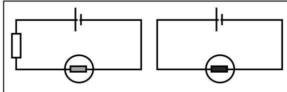
نلاحظ أن إضاءة المصباح أصبحت ضعيفة بعد إضافة الموصل الأومي على التوالى في الدارة الكهربائية كما نلاحظ انخفاض شدة التيار الكهربائي ونستنتج أن الموصلات الأومية تقاوم مرور التيار الكهربائي.
